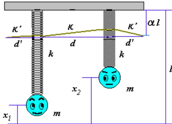
などとなる。ただし、 $d \gg \alpha x_1, \alpha x_2$  として近似をとった。実際の使用時にゴムは約2倍に伸びていることも考慮する。系の位置エネルギーおよび運動エネルギーは、次のようになる。
