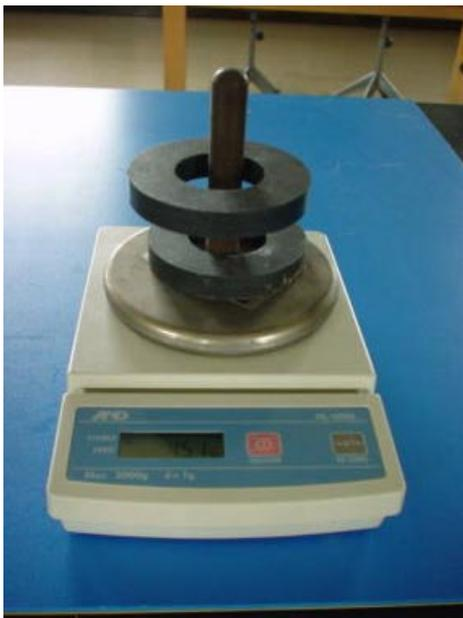
写真 4 ドーナツ磁石の浮上
