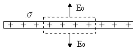
図1 孤立した帯電平板がつくる電場
