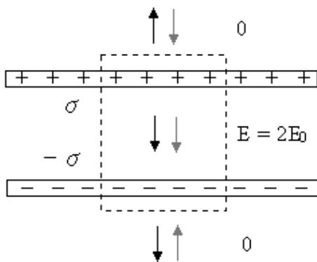
図2 平行板コンデンサーがつくる電場
