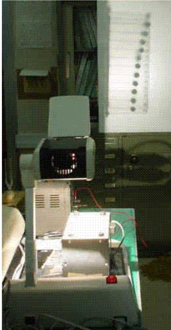
写真7 弦定常波実験器にマジックテープで固定した共振計
