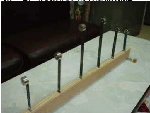
写真 1 金ノコ刃を板ばねとして利用した共振実験装置
